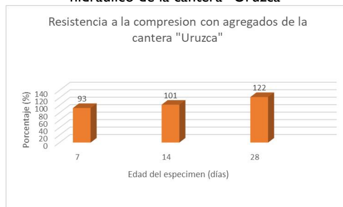
Figura 2: Resistencia a la compresión de especímenes cilíndricos de cemento hidráulico de la cantera “Uruzca”
